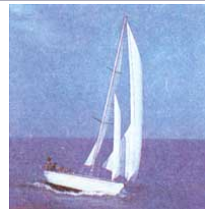
"Конрад-54" - морская крейсерско-гоночная яхта длиной 16,6 м, несущая паруса площадью 150 м 2 . Управление такой яхтой требует высокой квалификации экипажа, который в гонках состоит из 12 человек.
